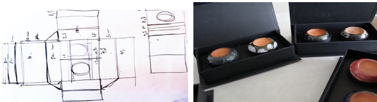
Figura 13. Izquierda: Plantilla o red para construcción de caja. Derecha: Caja de cartón construida con uso plantilla. Registro: Artista/Investigador/Docente.
