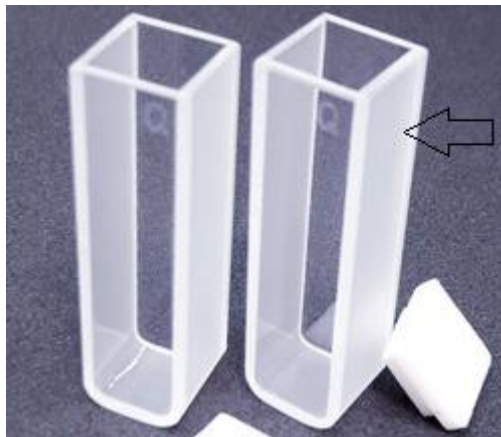
imagen 5. Cubeta cuarzo, parte esmerilada señalada con la flecha.
