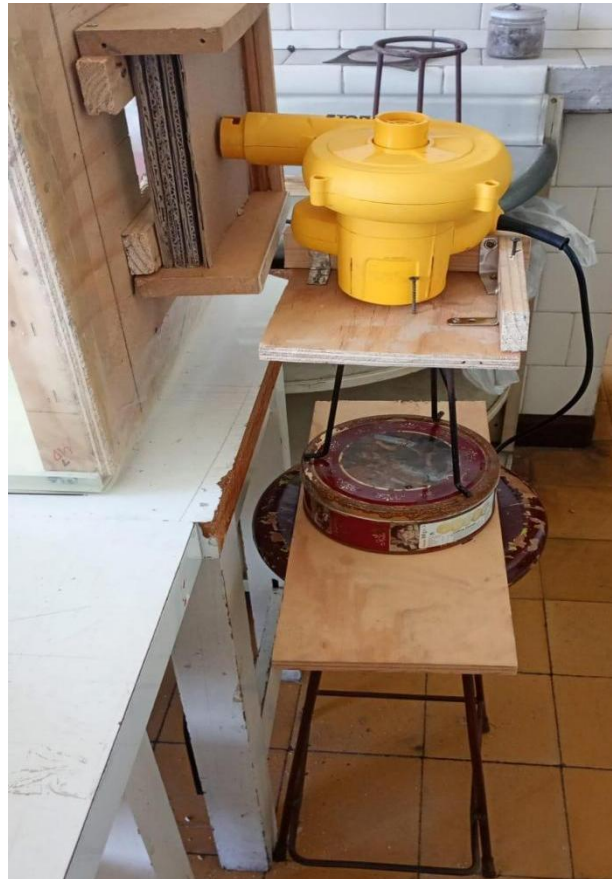
Figura 11. Fotografía sistema empleado para aplicar estímulo de viento.
