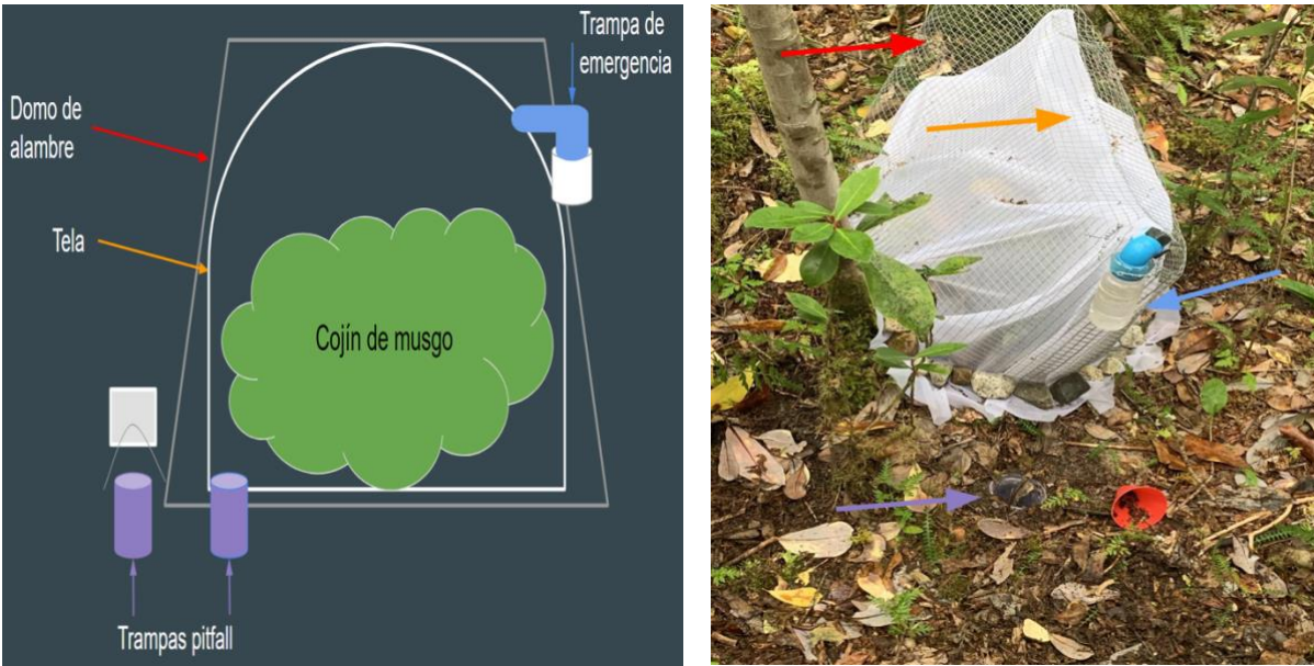
Figura 3a: Un diagrama de un domo de exclusión encima de un cojín de musgo con las trampas pitfall y emergencia. 3b: Un domo de exclusión puesto en sitio con trampas. En ambos, la flecha roja indica al alambre, la flecha naranja indica a la tela, las flechas moradas indican a las trampas pitfall, y la flecha azul indica la trampa de emergencia.
